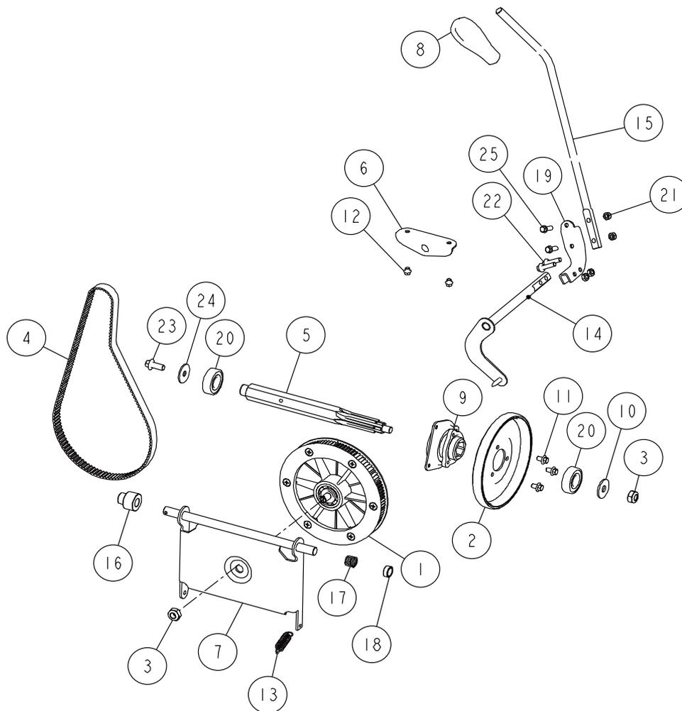
COMPONENTS LIST / CLUTCH,DRIVE クラッチ、ドライブ
